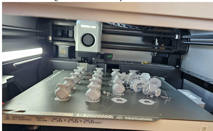
Imagem 40 - Placa de impressão com erros
