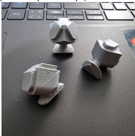
Imagem 22 - Impressão das peças de cantos e lateral
