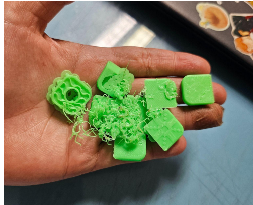
Imagem 39 - Peças com erros na impressão
