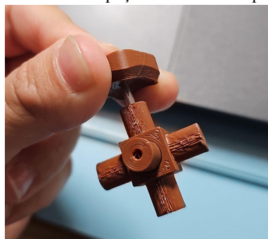
Imagem 21 - Núcleo e peça central unidas por parafuso
