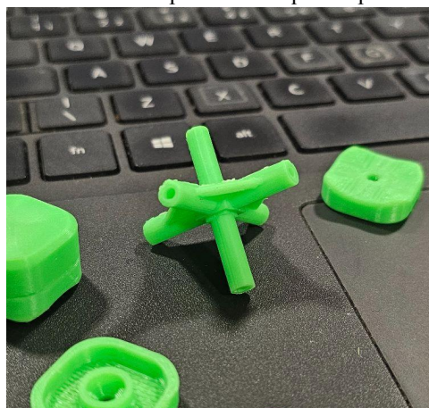
Imagem 15 - Núcleo impresso do arquivo Speed Cube 3x3
