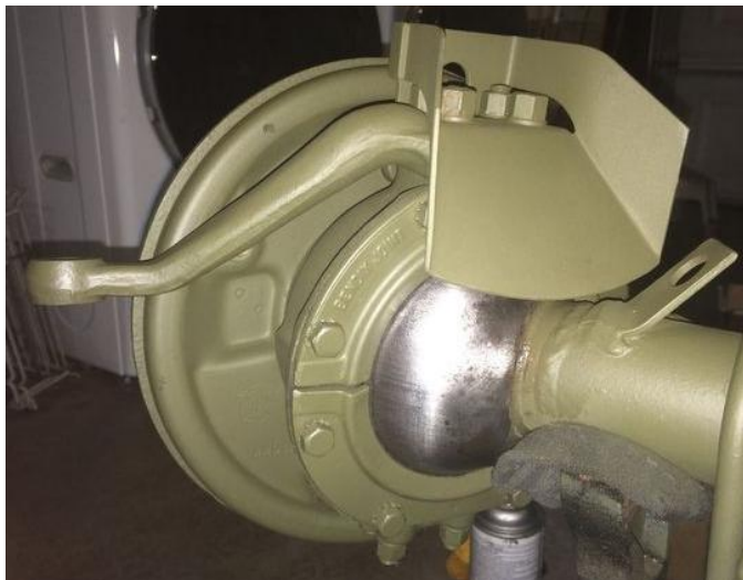
Figura 8- Munhão do tipo Fechado veículo Willys MB
