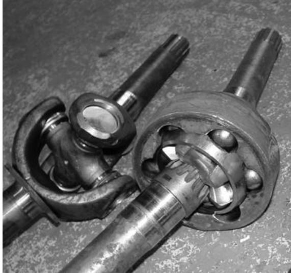
Figura 18 – Comparativo : Junta universal (esquerda) e Junta homocinética (direita)
