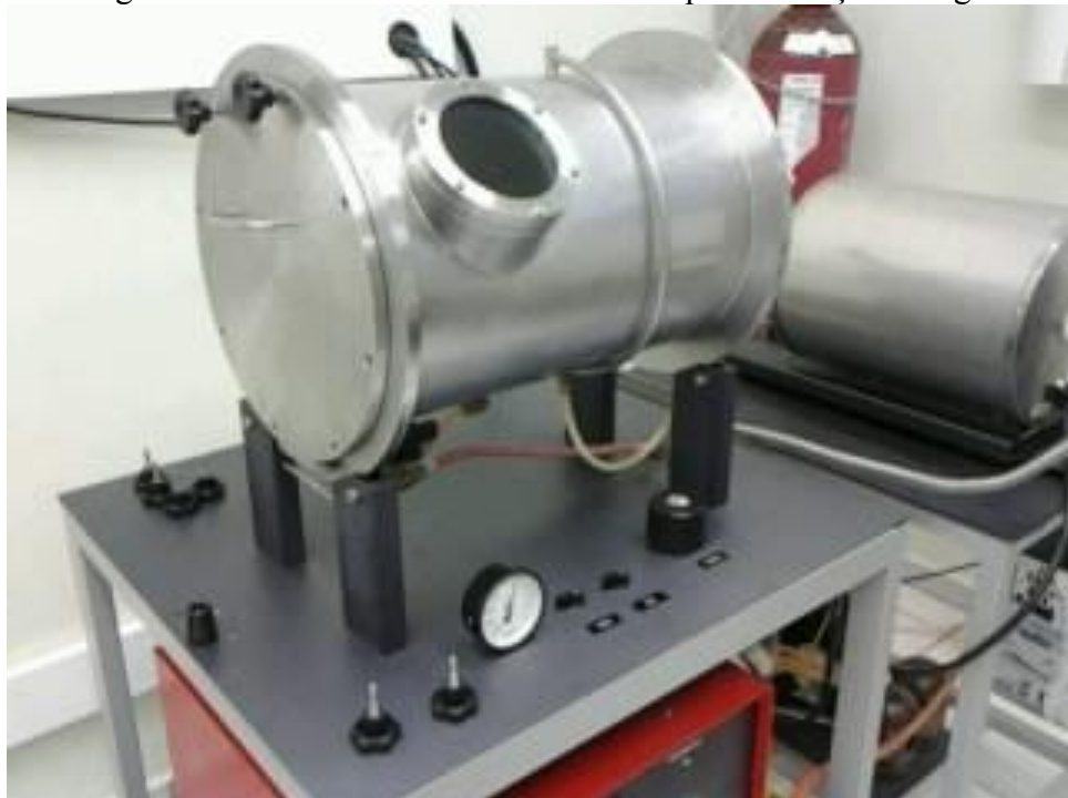
Figura 6 – Forno a arco voltaico utilizado para obtenção da liga
