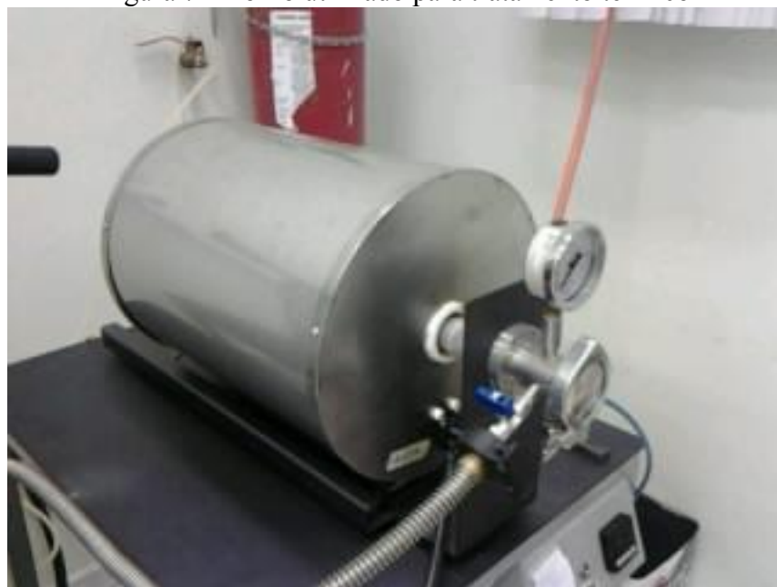
Figura 7 – Forno utilizado para tratamento térmico
