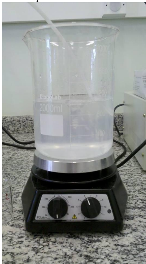
Figura 13 - Preparo do SBF 5x com fluxo de \text{CO}_2
