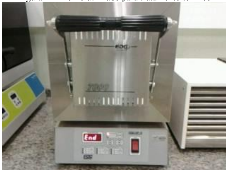
Figura 11 - Forno utilizado para tratamento térmico
