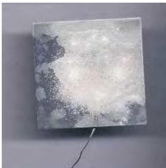
Figura 4: Eletrodo de Ti (5cm x 5cm) recoberto com TiO 2 e dopado com prata.
