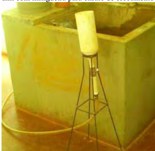
Figura 40 – Funil com mangueira para ensaio de escoamento por gravidade
