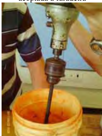
Figura 18 – Homogeneização da mistura com hélice acoplada à furadeira
