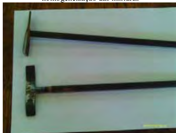
Figura 19 – Hélices que eram acopladas à furadeira para homogeneização das misturas
