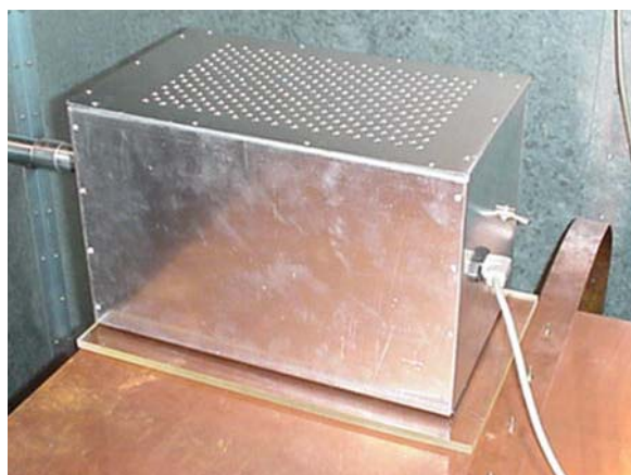
(b) Detalhe da blindagem genérica para EMI irradiada.
