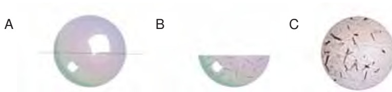
Figura 17: Fator Geometria. Em A tem-se a representação de uma forma tridimensional (esfera), onde são gerados os traços de forma aleatória, em B foi representado o polimento até o meio do cristal, e em C há uma visão em planta, onde são contados os traços oblíquos ao polimento e medidos os traços paralelos, os traços confinados.
