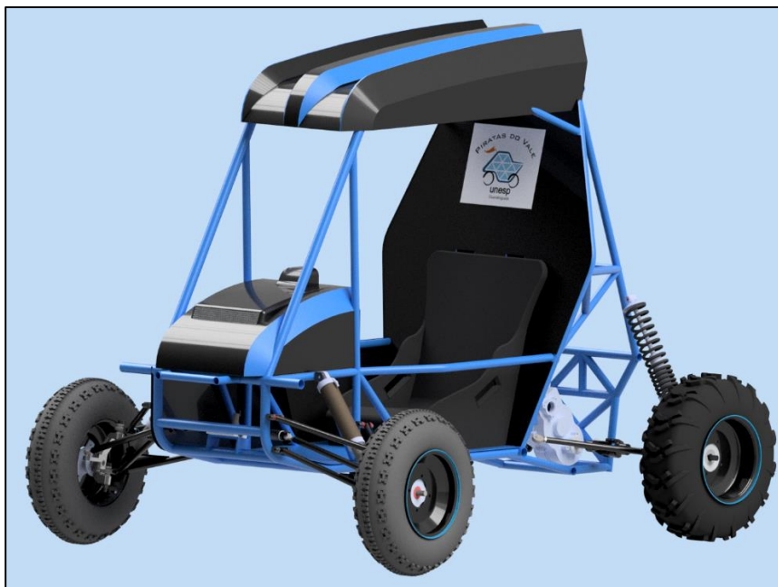
Figura 9 – Montagem em Autodesk Inventor do protótipo Baja SAE MB1317
