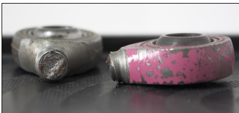
Figura 8 – Aspecto visual da fratura dos terminais rotulares
