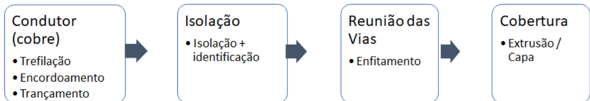
Figura 11 – Processo simplificado de construção de um Cabo Elétrico em cobre
