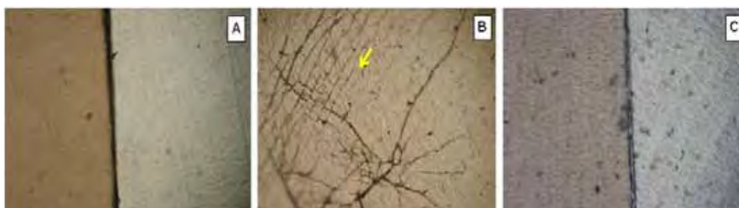
Figura 24 - Micrografia óptica dos filmes de PHB. (A) PHB biotratado, original (direita) e tratado (esquerda), (B) PHB fototratado, (C) PHB foto/biotratado, original (direita) e tratado (esquerda). Aumento de 400x. Seta indica fratura e deformação do filme.
