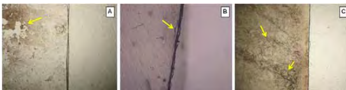
Figura 22 - Micrografia óptica dos filmes de PEBD. (A) PEBD biotratado, original (direita) e tratado (esquerda), (B) PEBD fototratado, original (direita) e tratado (esquerda), (C) PEBD foto/biotratado, original (direita) e tratado (esquerda). Aumento de 400x. Setas indicam adesão e pigmentação do filme, fraturas e deformações na borda, colonização de hifas respectivamente.
