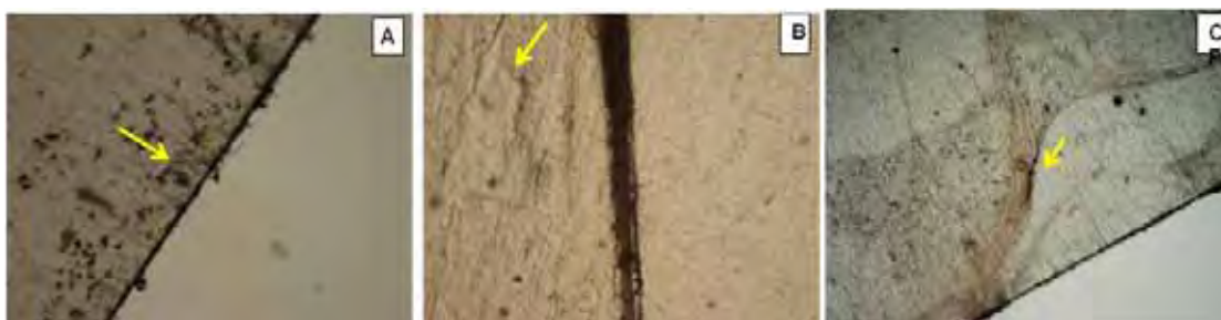
Figura 30 - Micrografia óptica da blenda 70:30. (A) biotratada, (B) fototratada, filme original (direita) e tratado (esquerda), (C) foto/biotratada. Aumento de 400x. Setas indicam presença de micro-organismos, falhas na superfície e pigmentação, respectivamente.
