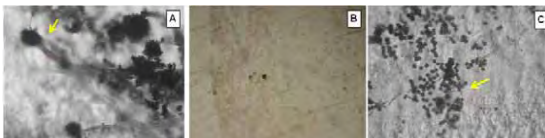
Figura 26 - Micrografia óptica da blenda 90:10. (A) biotratada, (B) fototratada, (C) foto/biotratada. Aumento de 400x. Setas indicam hifas com conidióforos presentes no filme, superfície pigmentada e conídios no filme, respectivamente.
