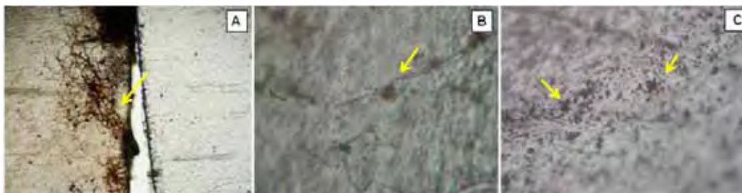
Figura 28 - Micrografia óptica da blenda 80:20. (A) biotratada, filme original (direita) e tratado (esquerda), (B) fototratada, (C) foto/biotratada. Aumento de 400x. Setas indicam hifas com conidióforos presentes no filme, superfície pigmentada e conídios no filme, respectivamente.
