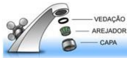
Figura 7: Instalação do arejador
