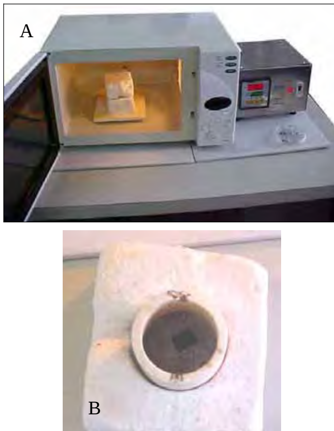
Figura 11: Fotos do forno de microondas modificado: (a) isolamento refratário e sistema de controle de temperatura, (b) porta amostra e susceptor de SiC.
