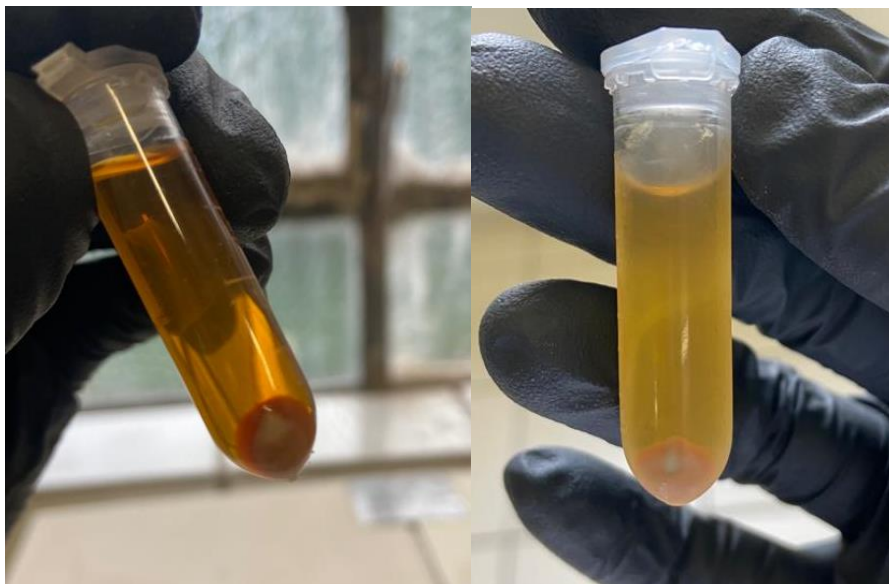
Figura 6. Formação do pellet com intensa pigmentação do sobrenadante. (à esquerda pellet formado logo após o armazenamento do extrato bruto extraído da fermentação; à direita pellet formado após processo de Salting-out, com seu sobrenadante mantendo coloração intensa).
