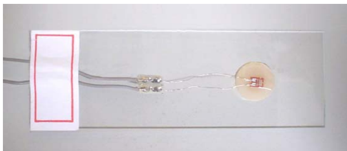
Figura 19: Amostra com extensômetro colado em sua superfície.
