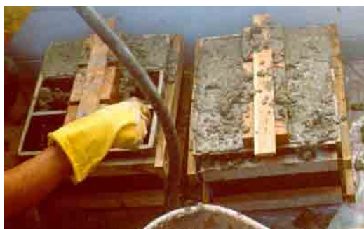
Figura 4.5 – Concretagem dos corpos-de-prova de madeira-concreto
