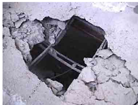
Figura 6.21 – Ruptura do tabuleiro misto de madeira-concreto com carregamento simulando o trem-tipo
