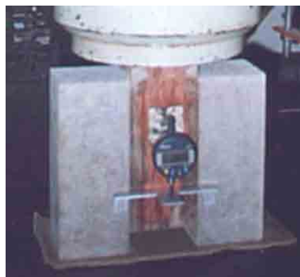
Figura 4.6 – Ensaio dos corpos-de-prova de madeira-concreto
