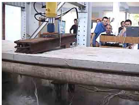
Figura 6.21 – Ruptura do tabuleiro misto de madeira-concreto com carregamento simulando o trem-tipo
