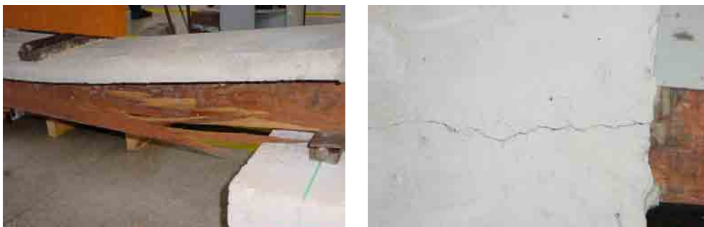
Figura 5.10 – Ruptura por tração na madeira e ruptura na linha de conectores da viga 7
