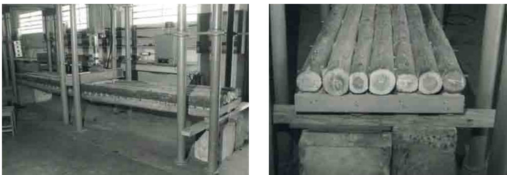
Figura 2.29 – Modelo de ponte na escala 1:4. Fonte: MATTHIESEN (1987)
