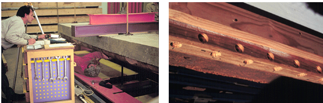
Figura 2.35 – Ensaio do sistema e transferência de cortante. Fonte: YTTRUP & NOLAN (1999)
