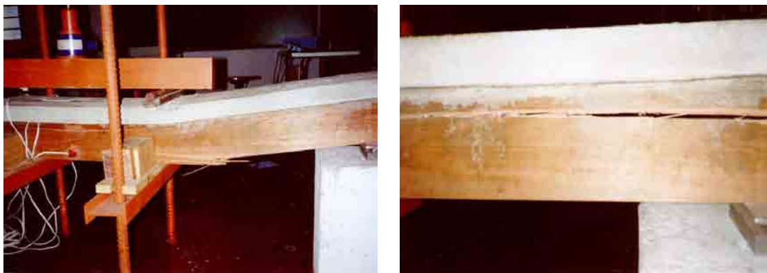
Figura 2.41 – Modo de ruptura das vigas mistas construídas com vigas de Eucalipto Grandis.
