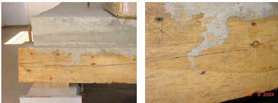
Figura 2.52 – Detalhe do cisalhamento na madeira. Fonte: SOUZA (2003)
