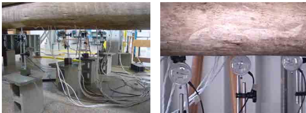
Figura 6.13 – Relógios comparadores no tabuleiro misto de madeira-concreto
