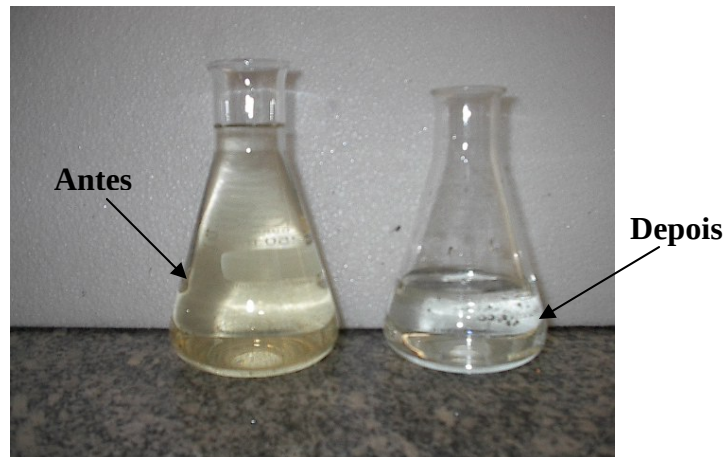
Figura 46: Água residuária antes e após a percolação pelo corpo de prova solo-cal (novo esquema experimental).
