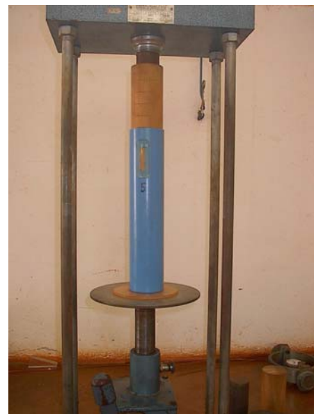
Figura 31: Compactação das Colunas.
