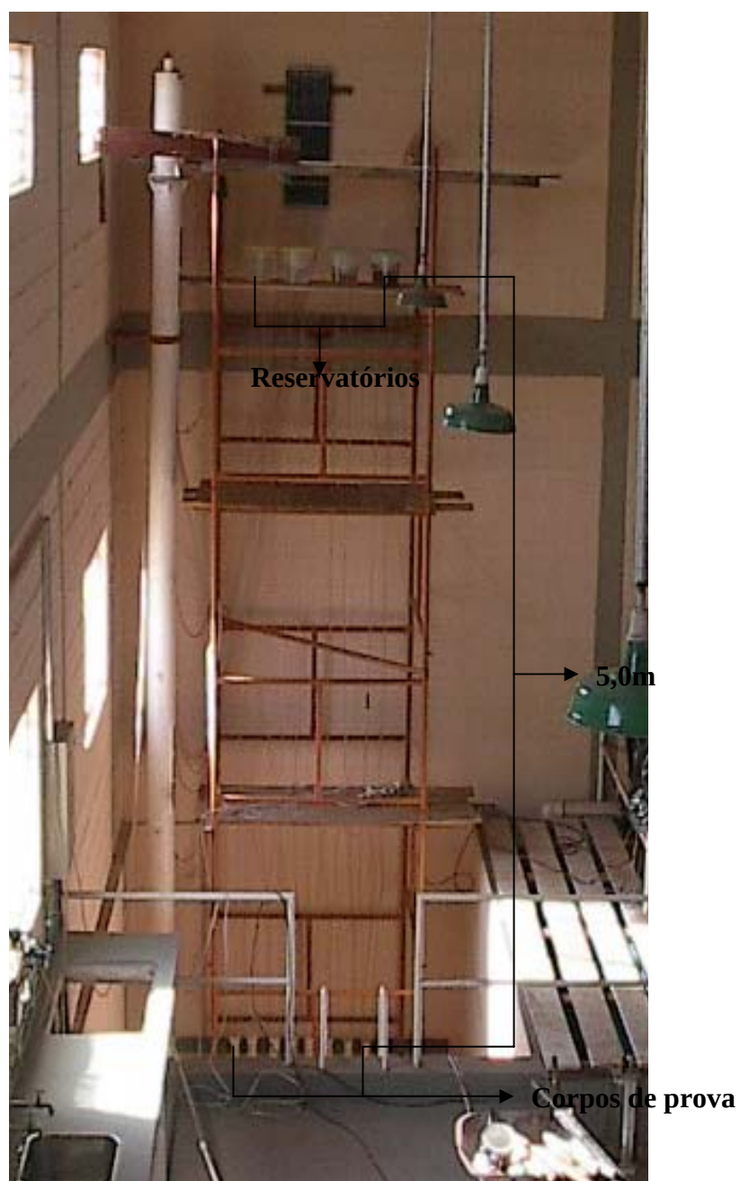
Figura 34: Dimensões do novo esquema experimental
