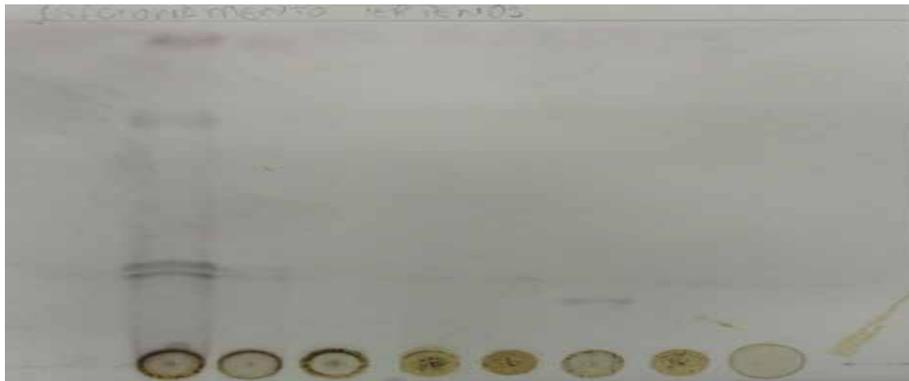
Figura 48 Cromatoplasa referente às frações EFS1 a EFS8, da esquerda para a direita. Revelador anisaldeído sulfúrico.
