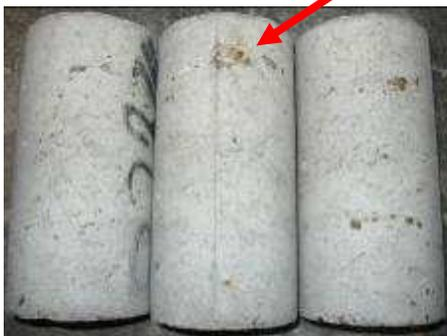
Figura 93. CCA e Borracha - Ensaio de Ciclagem.
