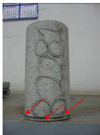
Figura 77. Demarcação da profundidade de imersão em água.
