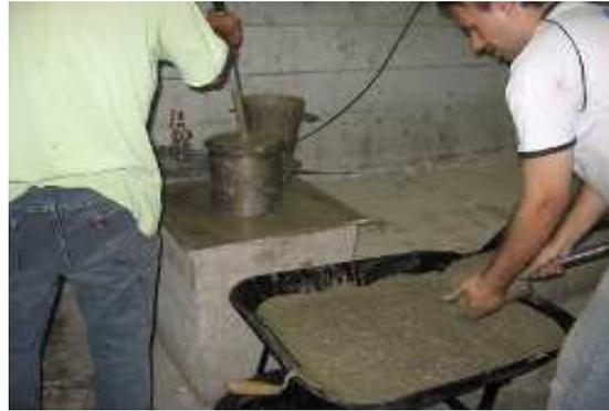
Figura 46. Moldagem do ensaio incorporação de ar.
