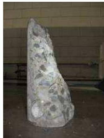
Figura 70. Fragmentação do CP sem borracha após ruptura.
