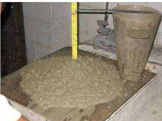
Figura 62. Consistência do concreto com adição de Sílica Ativa e Borracha.
