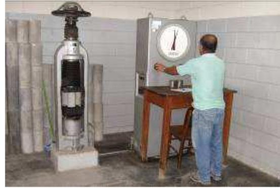
Figura 50. Ruptura dos CPs
