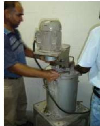
Figura 56. Inserção das pás giratórias para início do ensaio.
