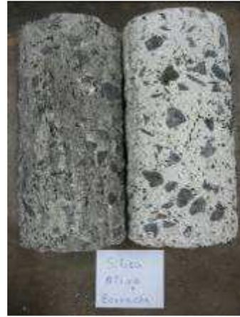
Figura 99. SA e Borracha - após a retirada do cálcio da superfície.
