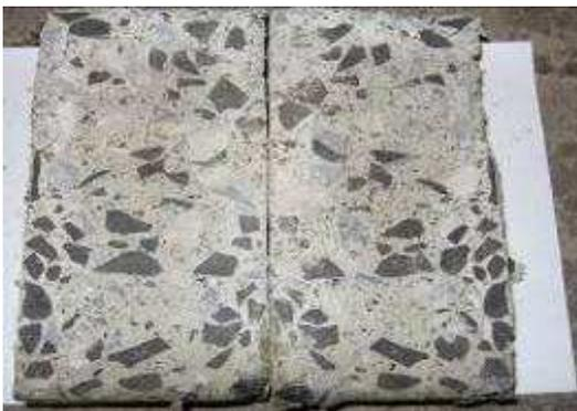
Figura 82. Lâmina d'água para CPs com CCA e Borracha.
