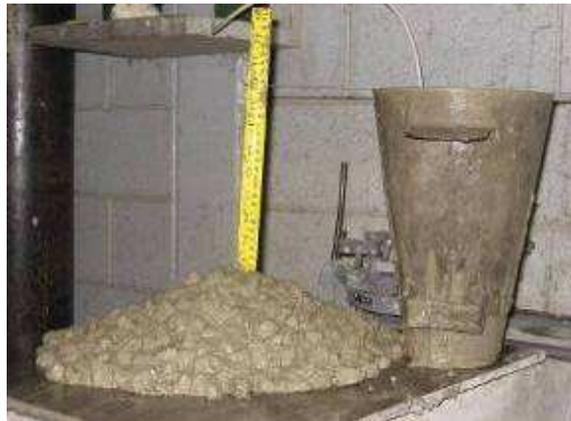
Figura 61. Consistência do concreto com adição de Sílica Ativa.
