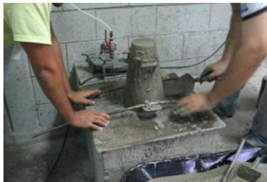
Figura 44. Ensaio de Consistência do concreto.
