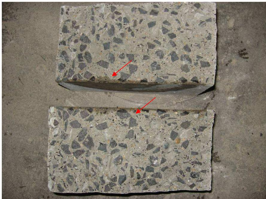
Figura 89. Lâmina d'água para CPs com SA e Borracha.
