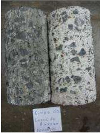
Figura 98. CCA e Borracha - após a retirada do cálcio da superfície.
