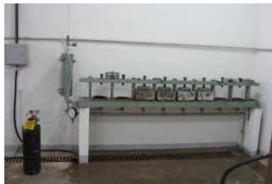
Figura 52. Ensaio de Penetração de água sobre pressão.
