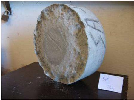
Figura 106. Abrasão/Erosão SA – Referência.
