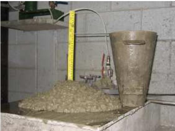
Figura 60. Consistência do concreto com adição de CCA.
