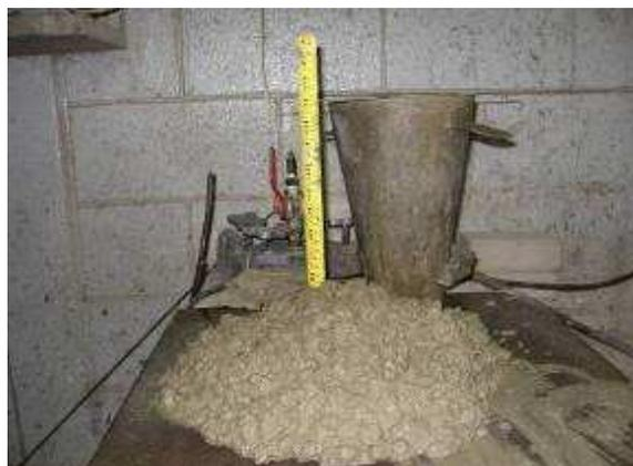
Figura 63. Consistência do concreto com adição de CCA e Borracha.
