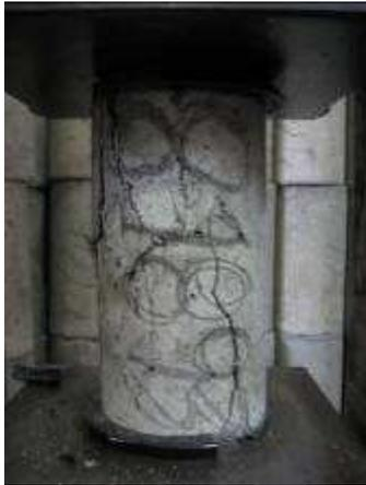
Figura 67. Ruptura do CP com Borracha.
