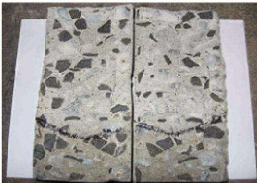
Figura 80. Lâmina d'água para CPs com CCA.
