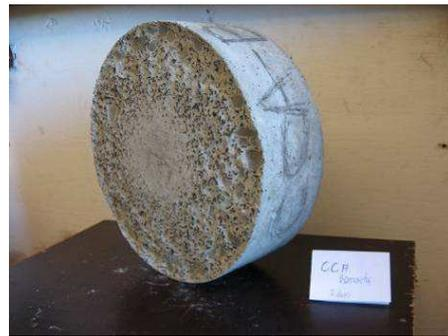
Figura 109. Abrasão/Erosão CCA – Borracha.
