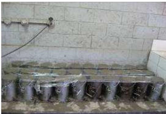
Figura 42. Moldagem corpos-de-prova para ensaios.
