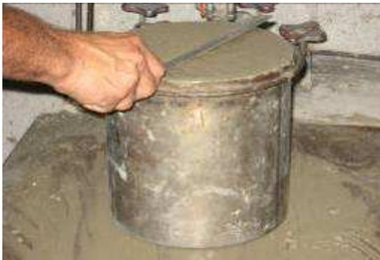
Figura 47. Retirada do excesso de concreto.
