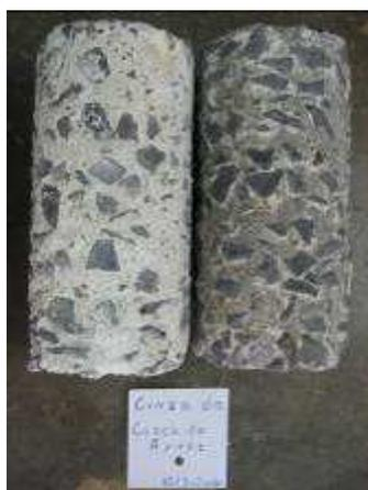
Figura 96. CCA - após a retirada do cálcio da superfície.
