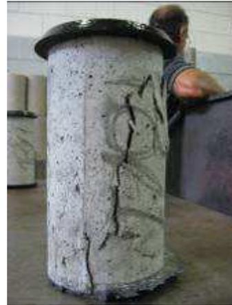
Figura 68. Ruptura sem estilhaçamento do CP com Borracha.
