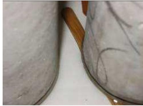
Figura 79. Detalhe da altura d'água e do suporte para impedir contato do CP com o fundo do aparato de ensaio.
