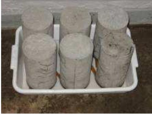
Figura 78. Aparato para realização do ensaio de Absorção por Capilaridade.
