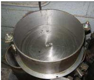
Figura 54. Forma ensaio de Abrasão.
