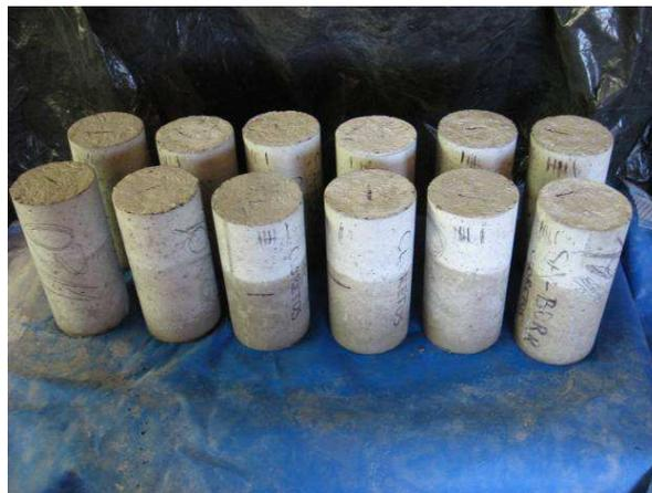
Figura 100. Secagem dos CPs à temperatura ambiente.
