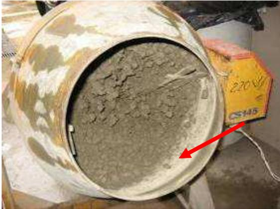
Figura 58. Concreto antes da adição do aditivo.
