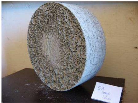
Figura 108. Abrasão/Erosão SA – Borracha.
