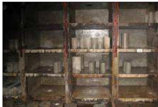
Figura 43. Armazenamento em câmara úmida.
