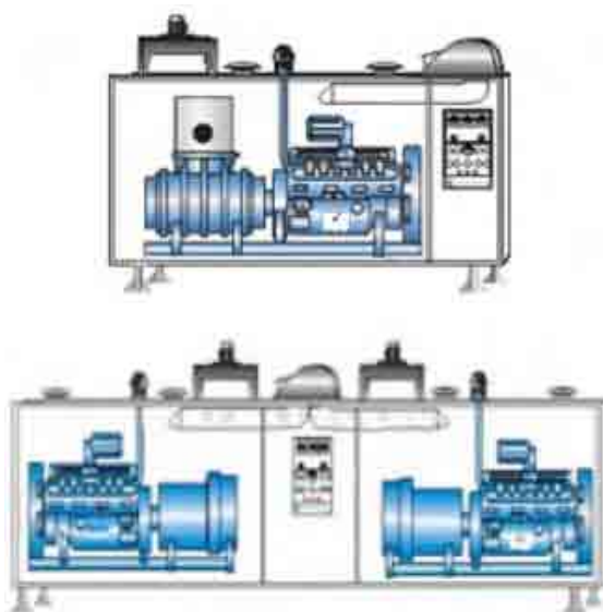
Figura 42: Moto geradores em contêineres
