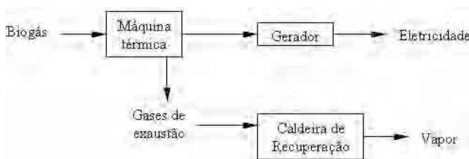
Figura 36: Sistema de cogeração
