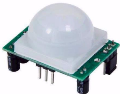
Figura 15. Sensor de movimento PIR.
