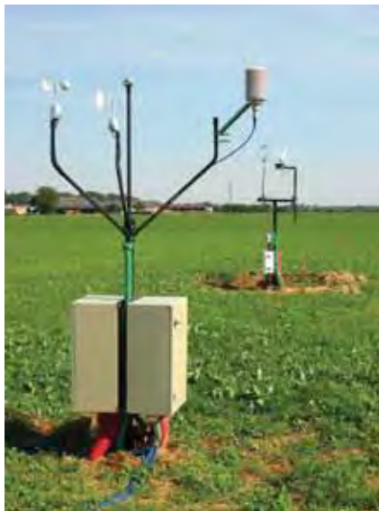
Figura 11. Dispositivo de medida de fluxo de \text{CO}_2 pelo método dos fluxos turbulentos: anemômetro sônico 3D e analisador \text{CO}_2/\text{H}_2\text{O} .
