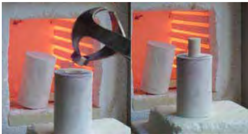
FIGURA 12 - Pastilha cerâmica e pistão colocados no cilindro de revestimento
