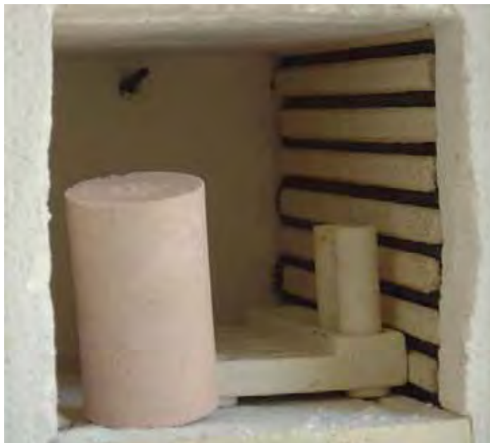
FIGURA 11 – Cilindro de revestimento e pistão de óxido de alumínio no forno à 700°
