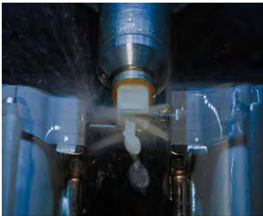
FIGURA 22 – Corte da restauração sob lubrificação
