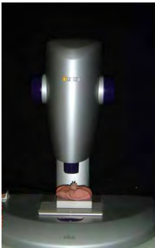
FIGURA 17 – Modelo em gesso Dentona sendo escaneado por Scanner Ineos
