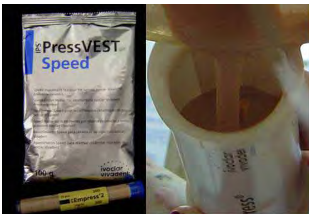
FIGURA 10 - Padrões de cera sendo incluídos em revestimento
