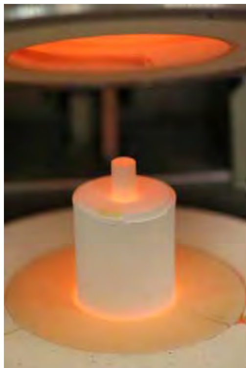
FIGURA 14 - Cilindro posicionado no centro do forno de injeção EP600
