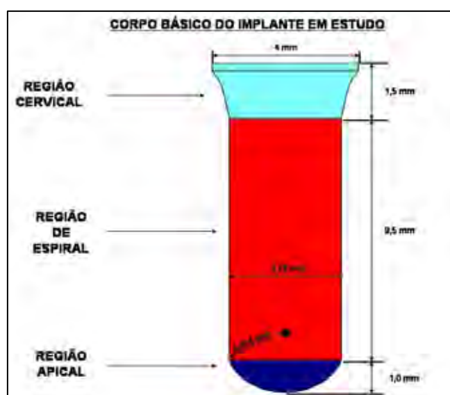
Figura 7 - Corpo básico do implante em estudo.
