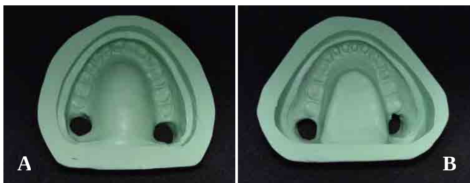
FIGURA 17- Moldes para enceramento maxilar (A) e mandibular (B), cada um com um canal de alimentação e um de escape.
