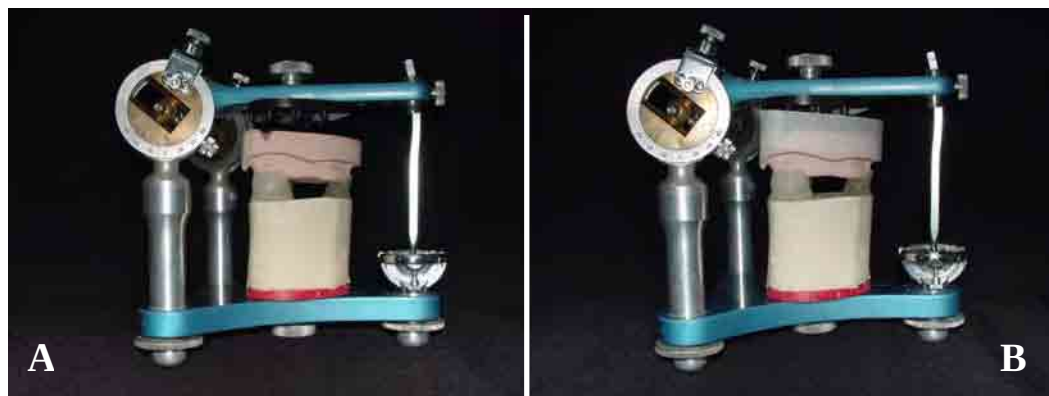
FIGURA 19- Montagem em articulador do modelo maxilar. A: Modelo indexado sendo posicionado sobre o Jig A; B: Fita Crepe ao redor do modelo, para posterior vazamento com gesso tipo II.
