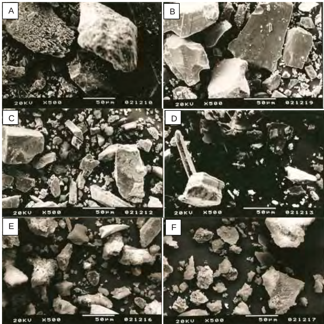
Figura 17 - Micrografias obtidas por MEV para os resíduos do ensaio de biolixiviação em frascos agitados para os seguintes frascos: a) 0,0% abiótico; b) 0,0% inoculado; c) 0,25% abiótico; d) 0,25% inoculado; e) 5,0% abiótico; f) 5,0% inoculado.
