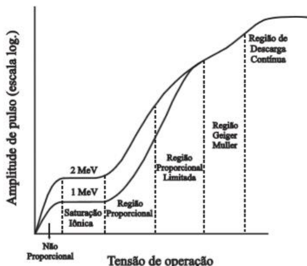
Figura 1- Curva de operação de um detector a gás, em função da diferença de potencial no gás contido em seu volume sensível. Fonte: Luiz Tauhata (2014) 9
