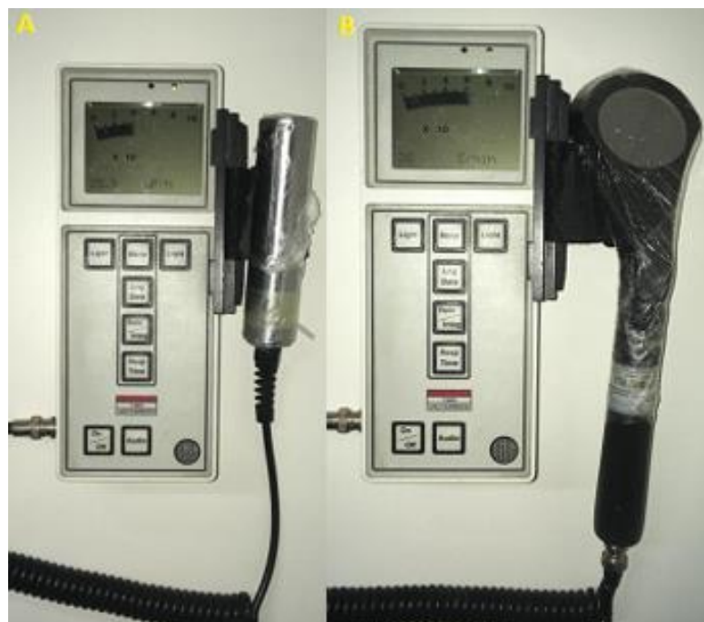
Figura 5- Detector do tipo Geiger-Müller digital, modelo Victoreen 190 . A: sonda do tipo cilíndrica acoplada. B: sonda do tipo pancake acoplada
