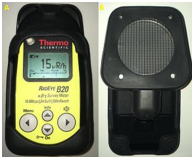
Figura 3- Detector do tipo Geiger-Müller digital, modelo Thermo Scientific Radeye B20 , na função taxa de exposição R/h. A: vista frontal. B: visão posterior da janela de volume sensível
