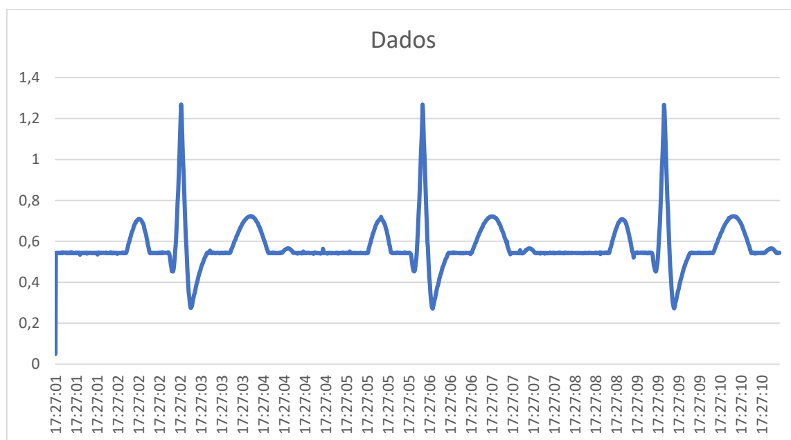
Figura 13: Sinal ECG gerado para 1500 pontos.
