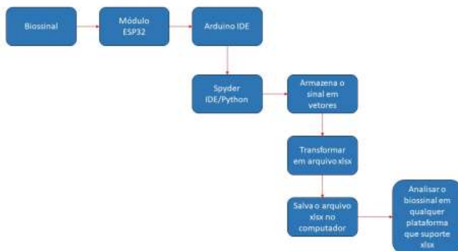
Figura 12: Fluxograma do algoritmo desenvolvido.
