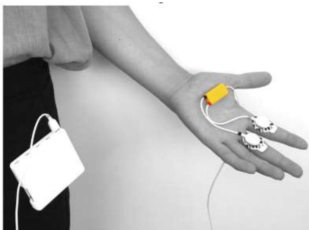
Figura VI.6 - Exemplo do posicionamento dos eletrodos [VI.5].
