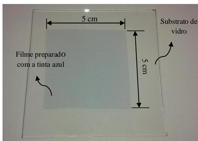
**Figura 3.3:** Imagem do filme preparado com a tinta azul usando a tela de 180 fios/cm<sup>2</sup>.
