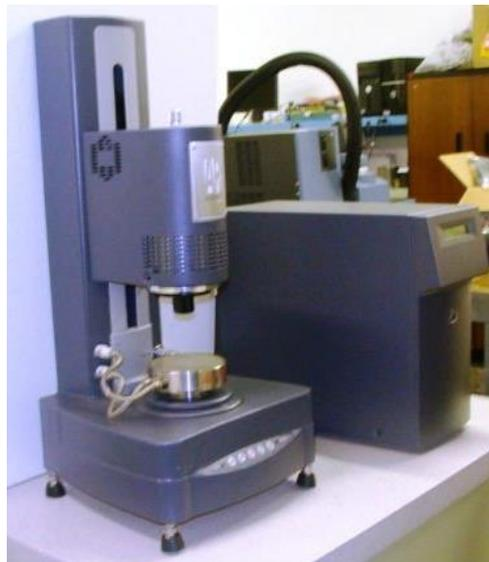
**Figura 3.5:** Imagem de um reômetro de torque utilizado nas análises de viscosidade das tintas.
