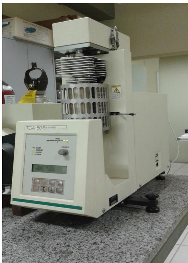
**Figura 3.8:** TGA utilizado para caracterização térmica da tinta condutora.
