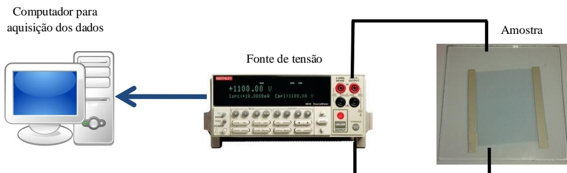
**Figura 3.6:** Esquema ilustrativo do aparato experimental usado para as medidas I vs. V a temperatura ambiente.
