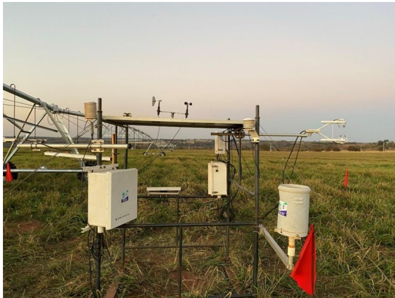
Figura 7 - Torre de instrumentos micrometeorológicos montada.
