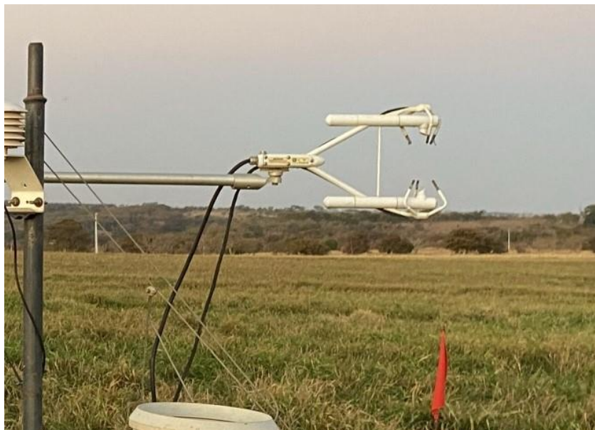
Figura 8 - Anemômetro sônico tridimensional IRGASON.
