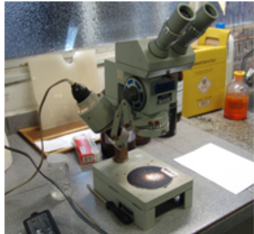
Lupa utilizada para selecionar os embriões que são mais adequados para a confecção de lâminas com montagens totais ou cortes seriados transversais.
