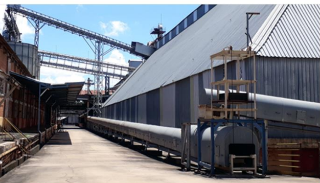
P7: "Essa aqui é uma fita transportadora. Os produtos do barracão eram lançados na fábrica nos eixos, armazenava-se os grãos aqui e enviava-se para serem industrializados" (Francisco, 2023)
