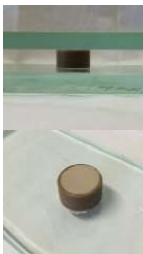
Figura 1. Confecção dos discos de silicone
