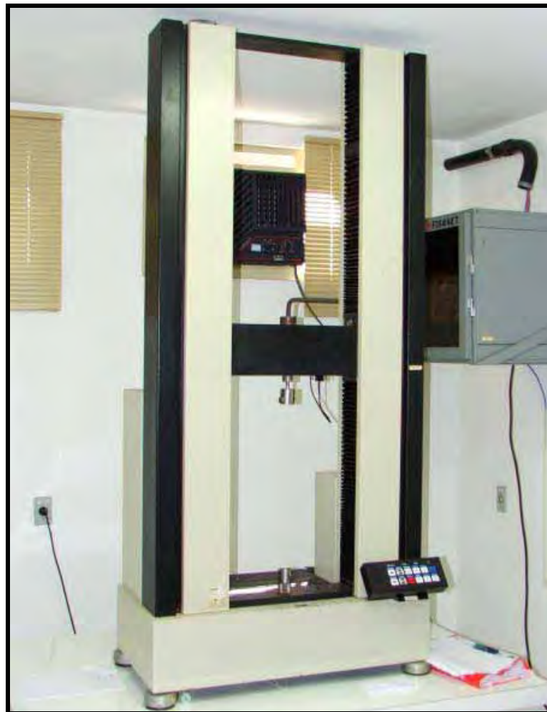
Figura 20 – Dinamômetro Emic DL10000
