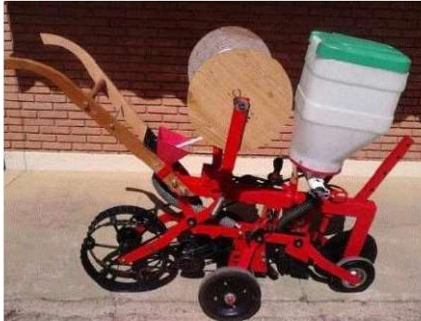
Figura 4 - Semeadora de fita de tração animal de uma linha
