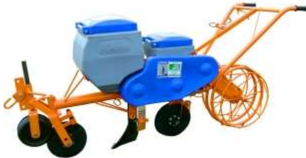
Figura 3 - Semeadora de tração animal de uma linha
