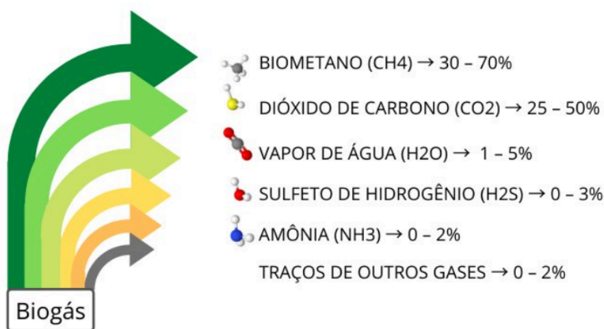
Figura 1- Representação esquemática da composição do biogás
