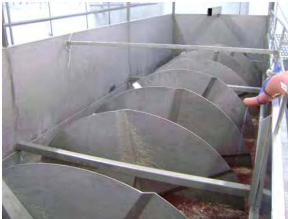
FIGURA 1. Tanque de pré-resfriamento por imersão em água ( chiller ).
