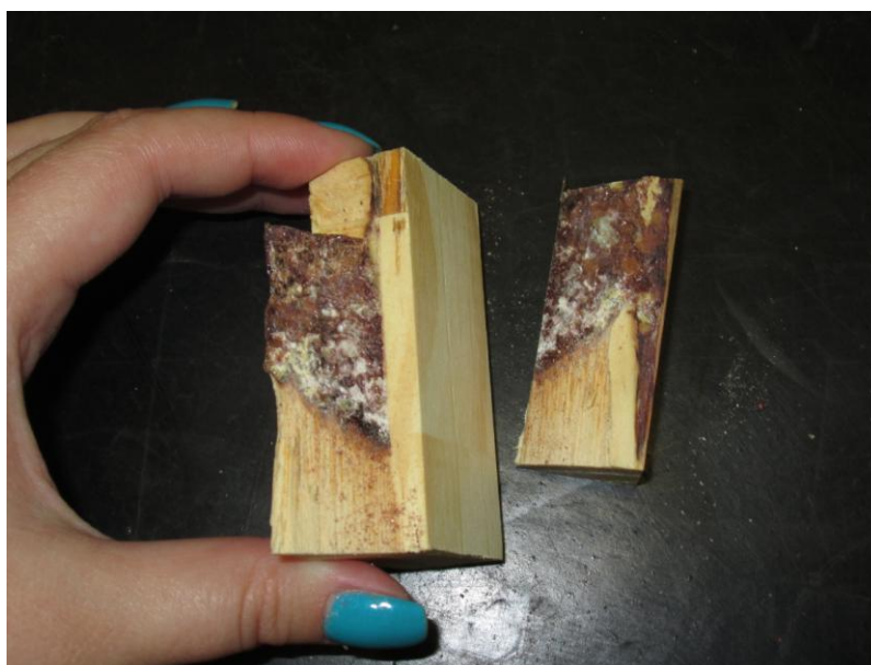
Figura 52: Ruptura no defeito na madeira (nó), teste de cisalhamento.
