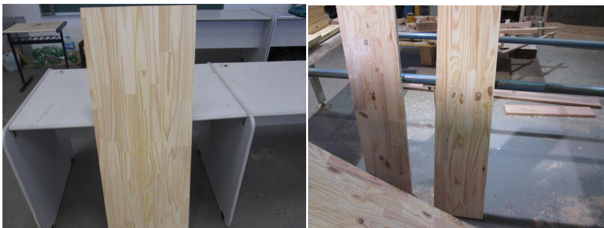
Figura 23: a) Painel de EGP classe A e b) Painel de EGP classe C, produzidos pela indústria local.
