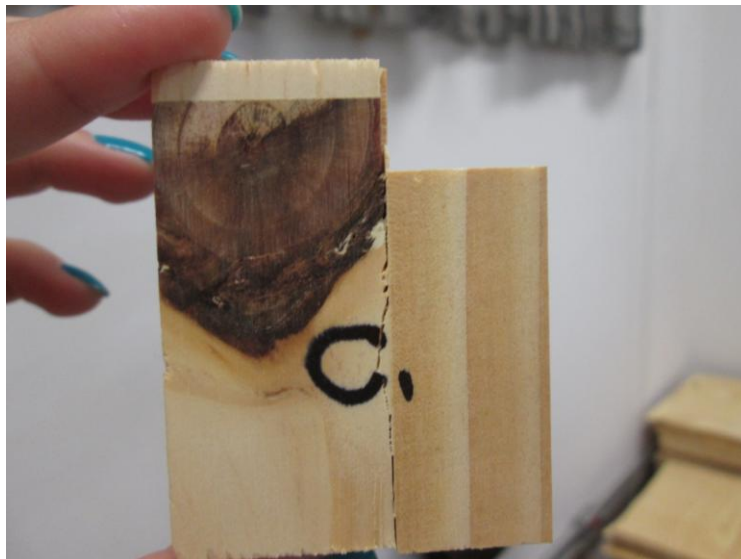
Figura 51: Ruptura na linha de cola, painel classe C.
