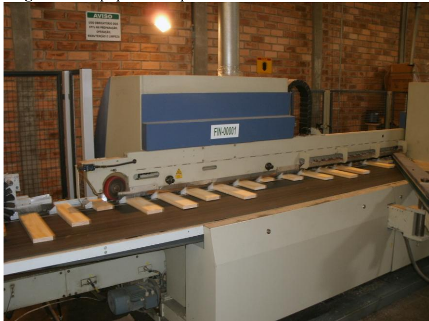
Figura 15: Equipamento que confecciona os dentes na madeira.
