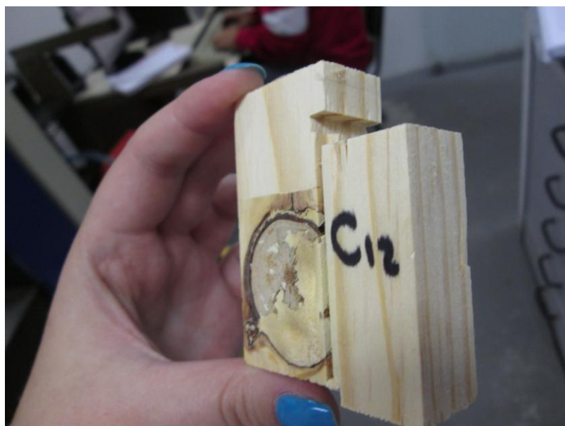
Figura 54: Ruptura na linha de cola com nó ao lado.
