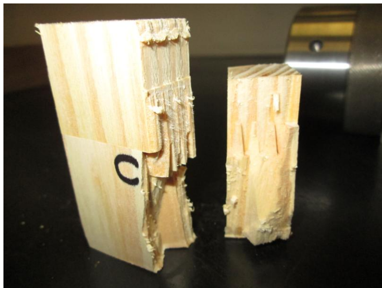
Figura 49: Ruptura na emenda de finger joint , painel classe A.
