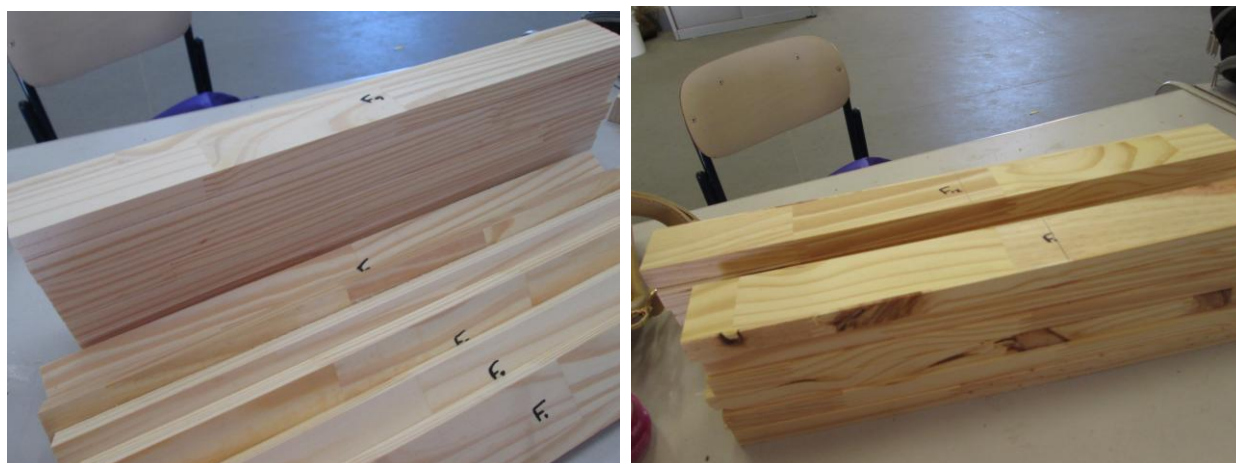
Figura 27: a) Corpos de prova de flexão, EGP classe A e b) corpos de prova de flexão, EGP classe C.
