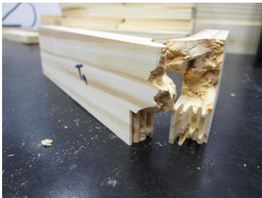
Figura 44: Ruptura na emenda de finger joint e na madeira no teste de tração.
