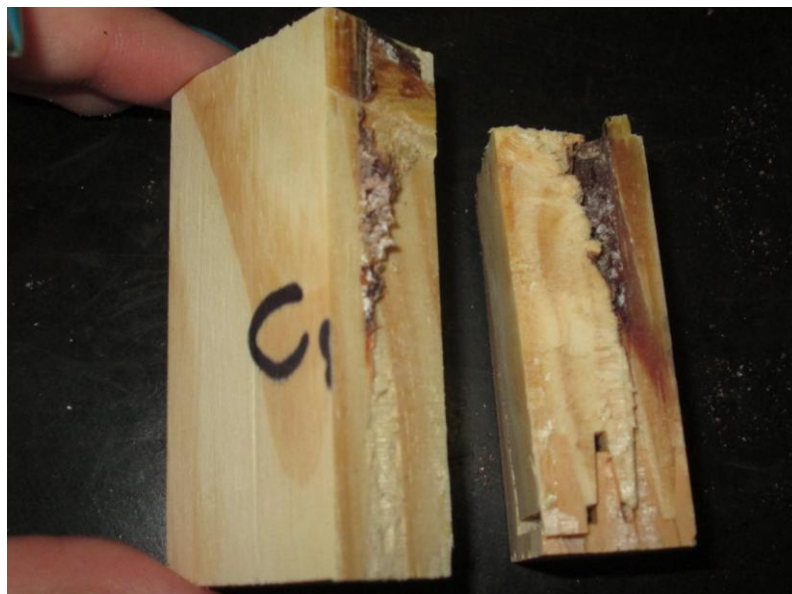
Figura 53: Ruptura na emenda de finger joint e no defeito da madeira.
