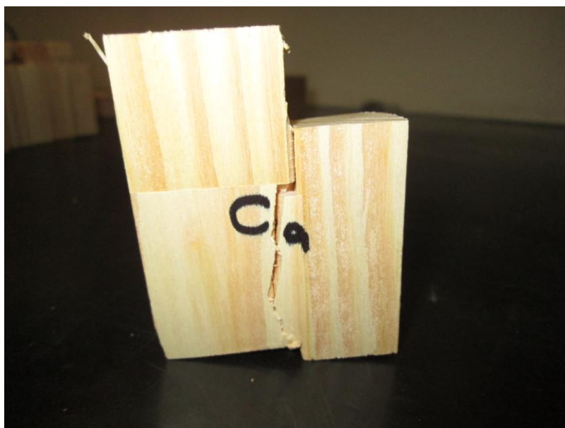
Figura 50: Ruptura na madeira, painel classe A.
