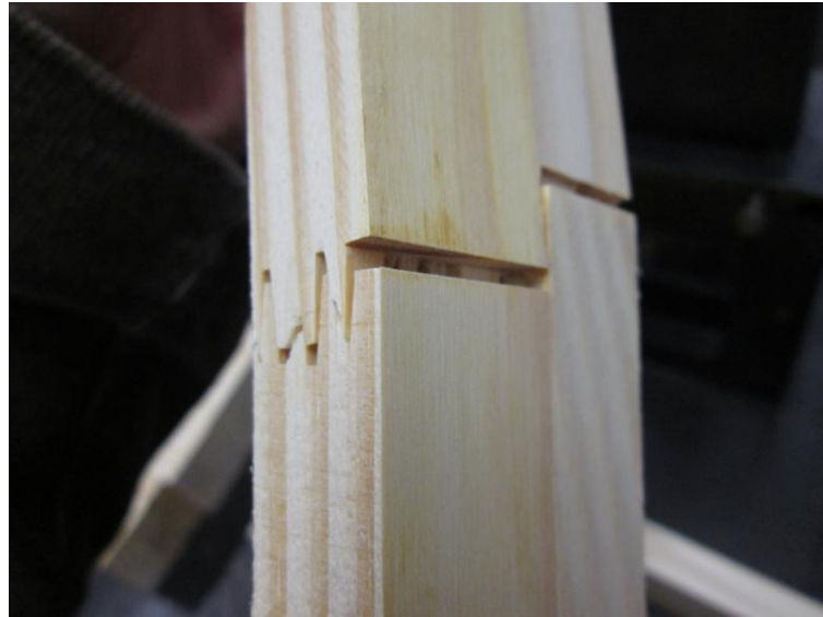
Figura 34: Ruptura na emenda de finger joint , painel classe A.
