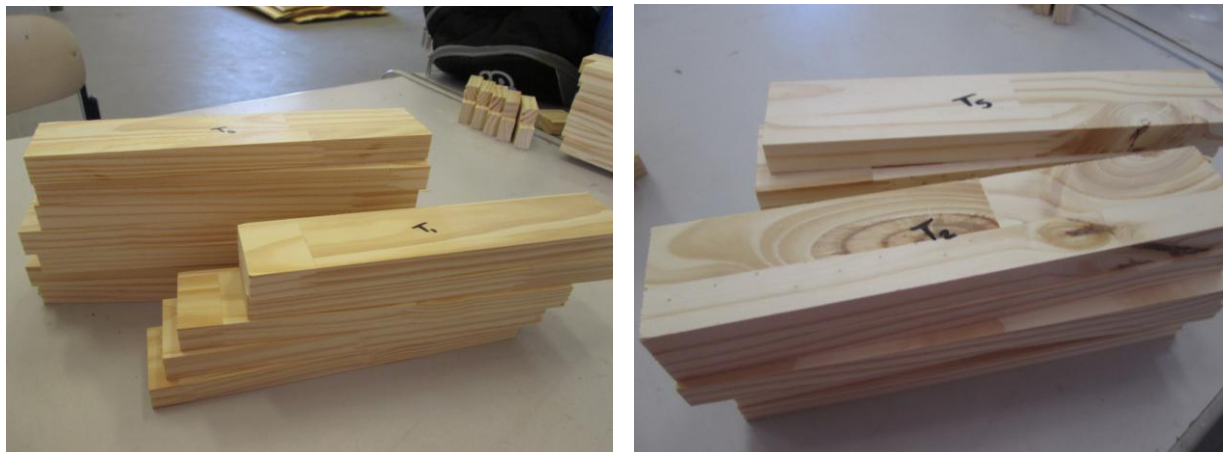
Figura 28: a) Corpos de prova de tração paralela às fibras de EGP classes A e b) corpos de prova de tração às fibras, EGP classe C.
