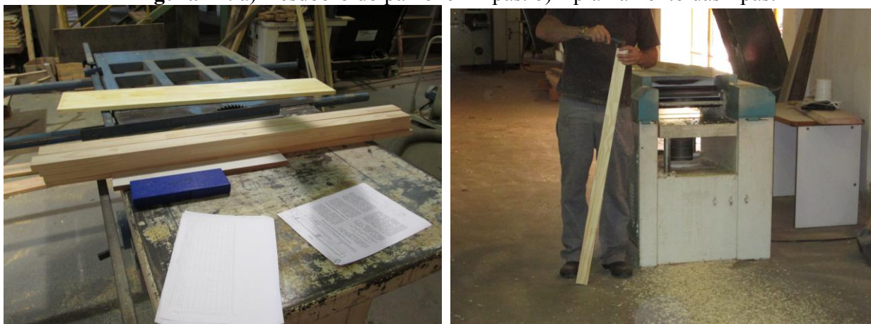
Figura 24: a) Desdobro do painel em ripas. b) Aplainamento das ripas.
