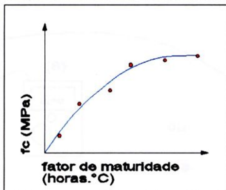
Figura 51 – Gráfico resistência à compressão x fator de maturidade, acrescido de linha de tendência obtido em laboratório.
