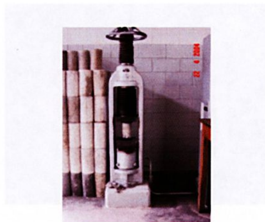
Figura 78 – Detalhe do cp sendo rompido
