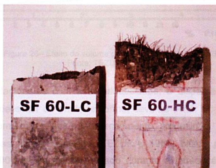
Figura 25 – Detalhes das seções de ruptura de corpos-de-prova de concreto de alto desempenho incorporado fibras de aço de baixo (LC) e alto (HC) teor de carbono
