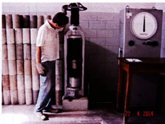
Figura 130 – Ensaio de compressão durante a cura térmica
