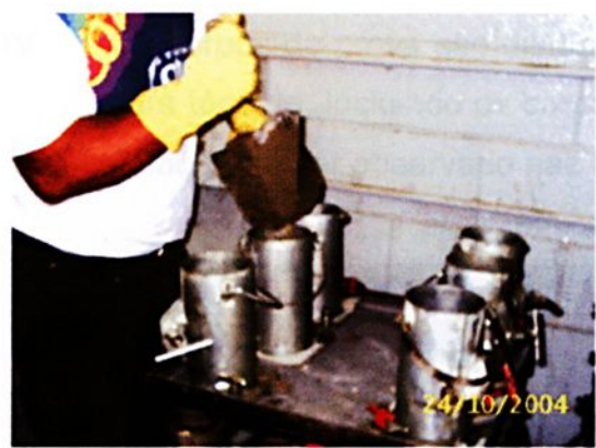
Figura 121 – Adensamento em mesa vibratória
