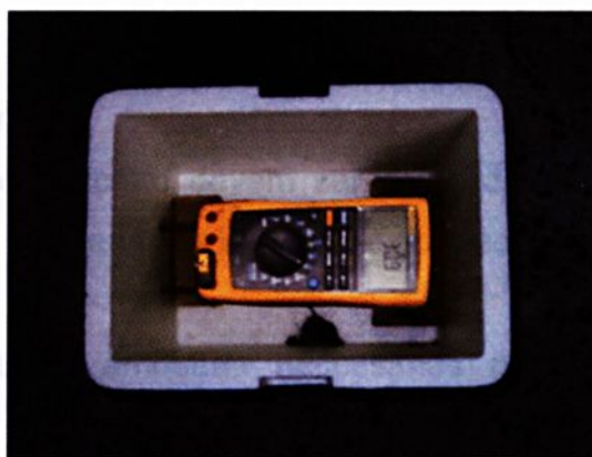
Figura 80 – Multímetro, protegido em caixa de isopor
