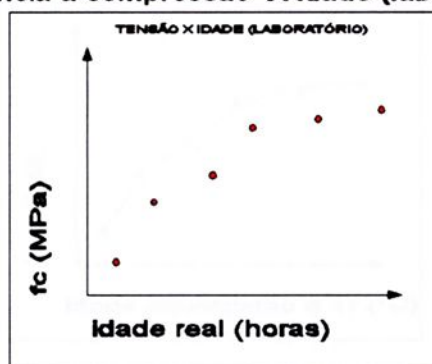
Resistência à compressão X Idade (laboratório)
