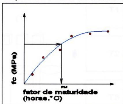
Figura 53 – Gráfico resistência à compressão x fator de maturidade.
