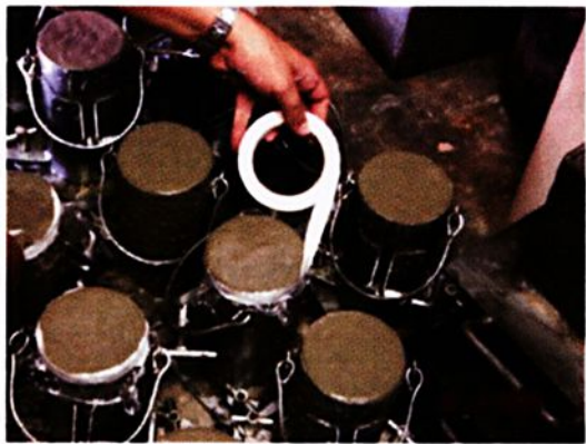
Figura 122 – Colocação de filtro plástico
