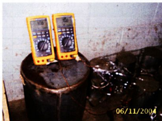
Figura 161 – Multímetros para registro das temperaturas
