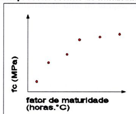
Figura 50 – Gráfico resistência à compressão x fator de maturidade, obtido em laboratório.
