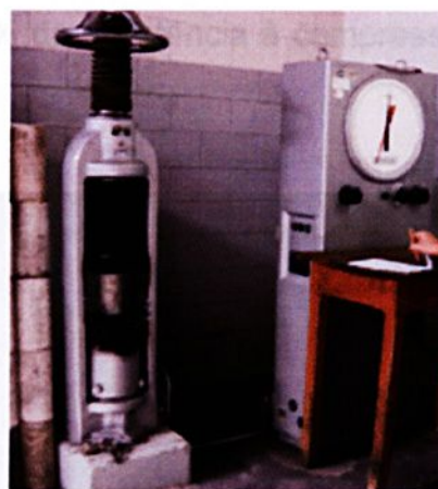
Figura 88 – Equipamento empregado no ensaio resistência a compressão
