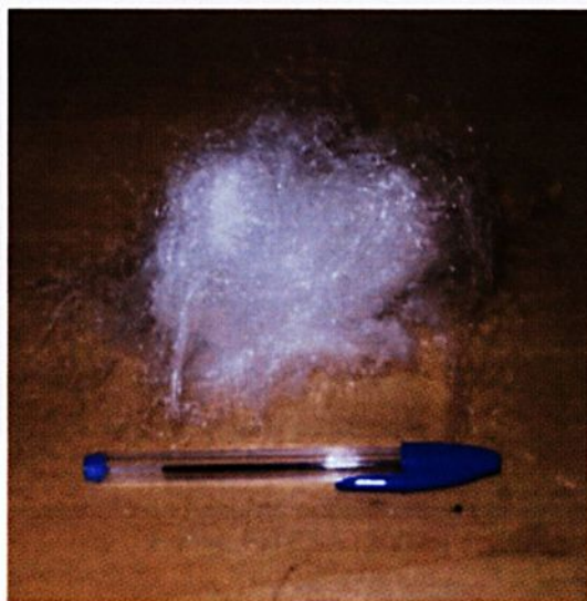
Figura 29 – Fibras de polipropileno utilizadas em concretos
