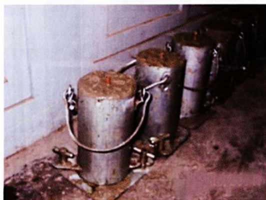
Figura 153 – Corpos-de-prova para monitoramento da temperatura
