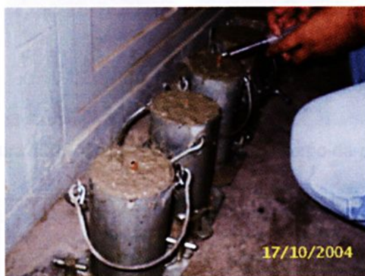
Figura 123 – Colocação do óleo, no cano de cobre
