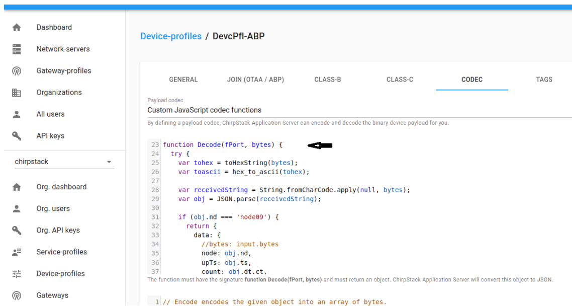
Figura 39 – Configuração da Integração do LoRaWAN ao Banco de Dados InfluxDB e indicação da função Decode .
