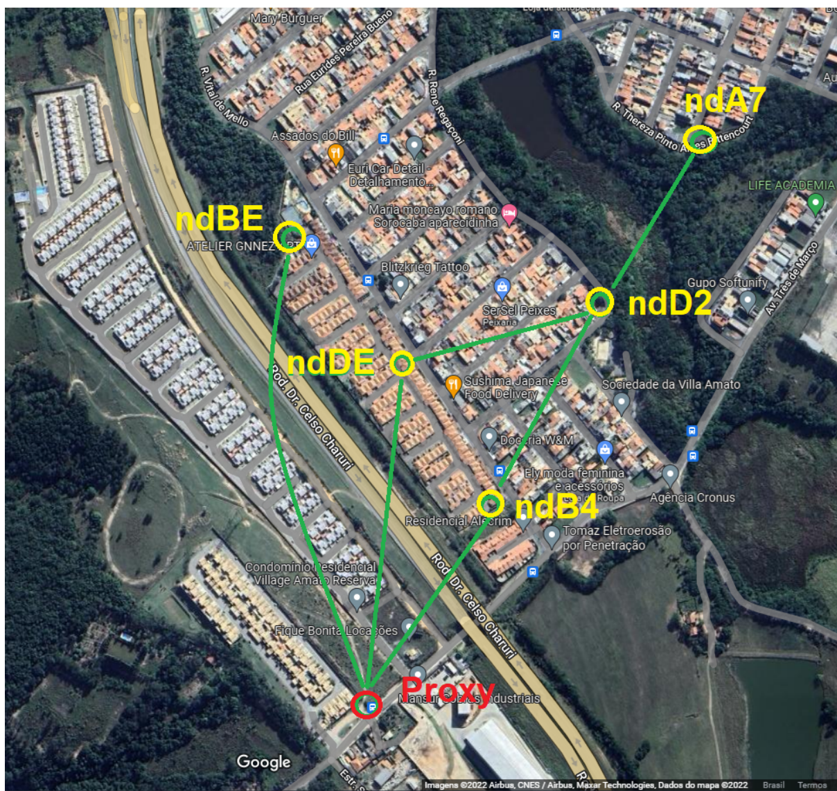
Figura 45 – Posicionamento dos dispositivos para o teste da rede LoRa em malha.
