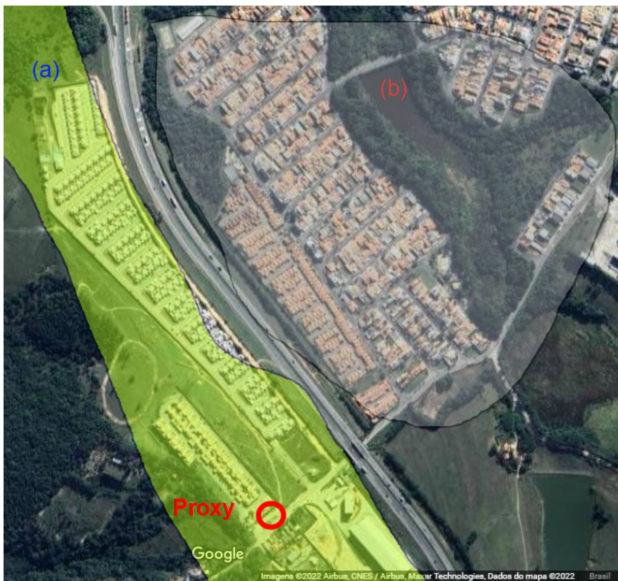
Figura 44 – Áreas de cobertura (a), sombra (b) para a rede LoRaWAN e o posicionamento do Proxy .
