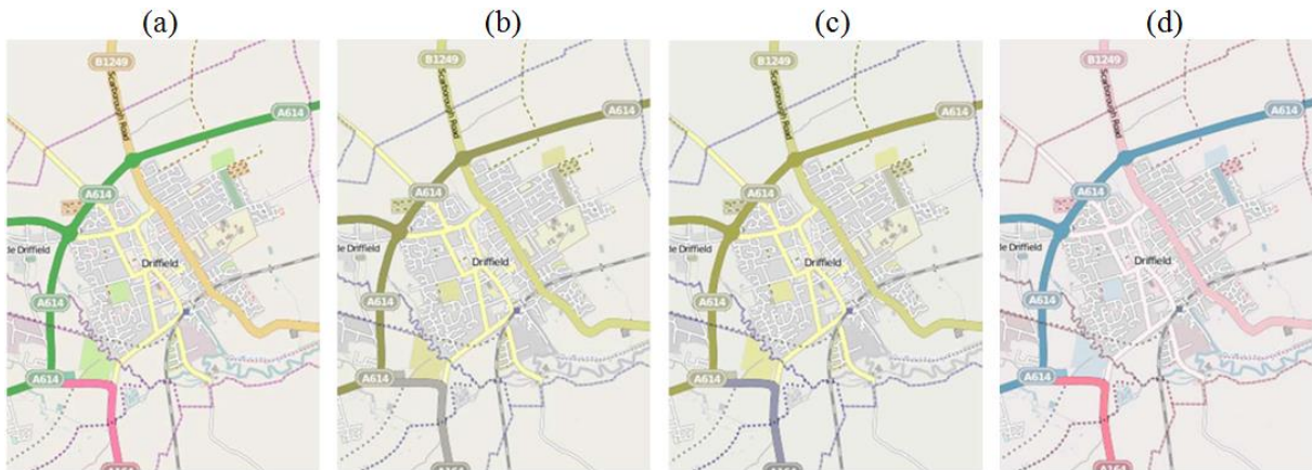
Figura 13 - Mapas do openstreetmap.org após o ajuste das cores conforme a visão de cores de pessoas normais (a), dicromatas deuteranopes (b), protanopes (c) e tritanopes (d).
