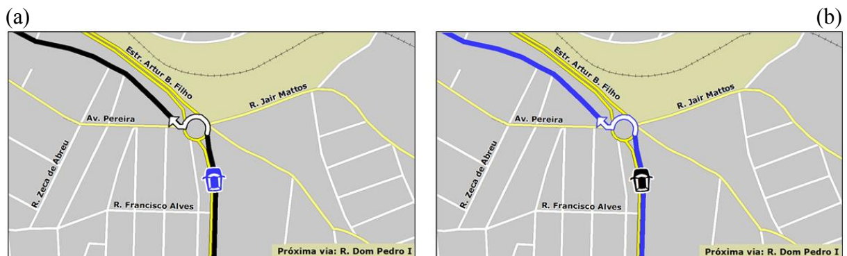
Figura 25 - Agrupamento perceptivo por cor entre a rota e o contorno da seta de direção de manobra, utilizando o preto (a) e o azul (b).
