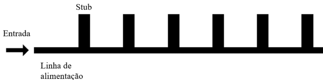
Figura 21 – Arranjo de antenas de microstrip composto por stubs de circuito aberto. (WU, 2016)
