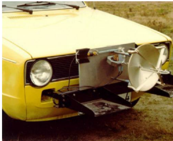
Figura 1 – Radar automotivo em 1970 (WU, 2016)
