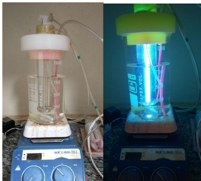
Figura 14: Reator utilizado, à esquerda desligado e à direita em operação.
