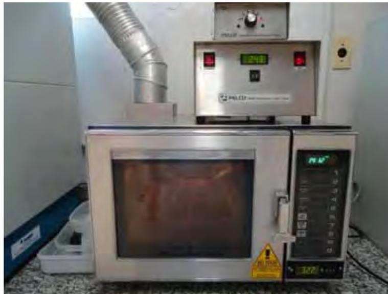
Figura 7 aparelho de micro-ondas PELCO 3441, (Ted Pella, Inc., CA, USA)
