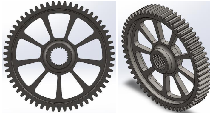
Figura 68 – Vista frontal e isométrica da segunda coroa, com alívio de massa.
