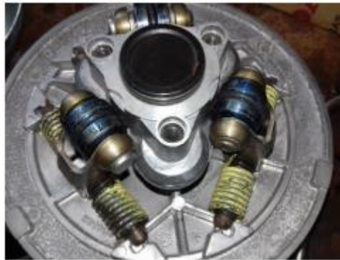
Figura 14 – Polia motora, e seus componentes internos.
