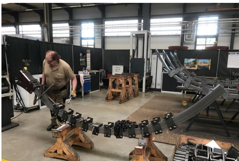
Figura 33: Confeção dos braços de arraste do rotor. (Cortesia SHW)
