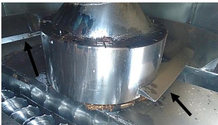
Figura 34: Sistema auxiliar de descarregamento atual.- Destaque para os braços rígidos soldados no tambor.
