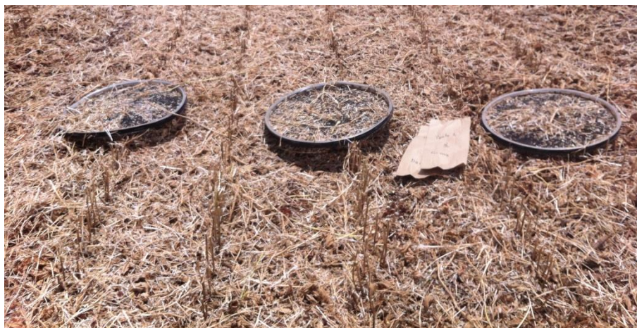
FIGURA 4 Esquema de amostragem de perdas na colheita mecanizada de soja
