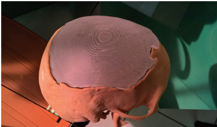
Figura 35- Implante final usinado em acrílico
