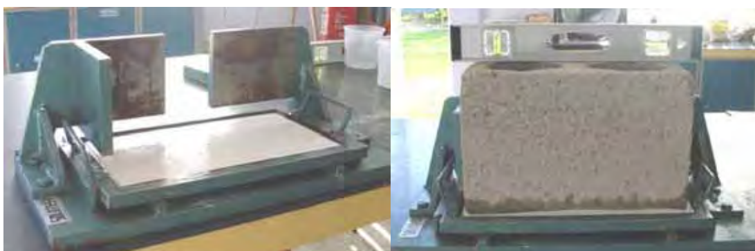
Figura 5.1 – Capeamento dos blocos
