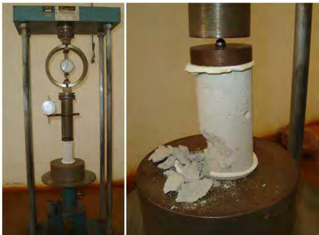
Figura 5.18 - Ensaio de compressão axial em prensa manual em CP de argamassa
