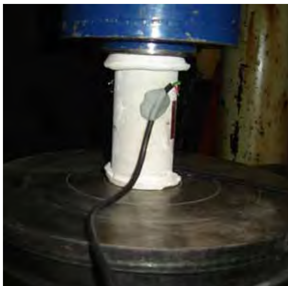
Figura 5.14 - Corpo-de-prova preparado para receber carregamento.
