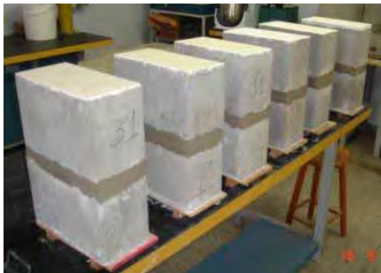
Figura 5.24 - Prismas assentados com argamassa A1 (PR2-A1).
