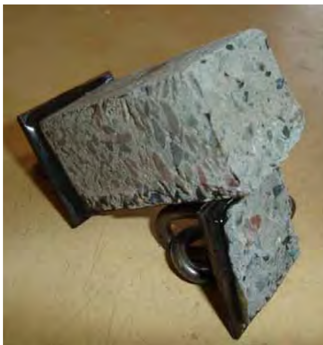
Figura 5.12 - Amostra de parede rompida após ensaio de tração.
