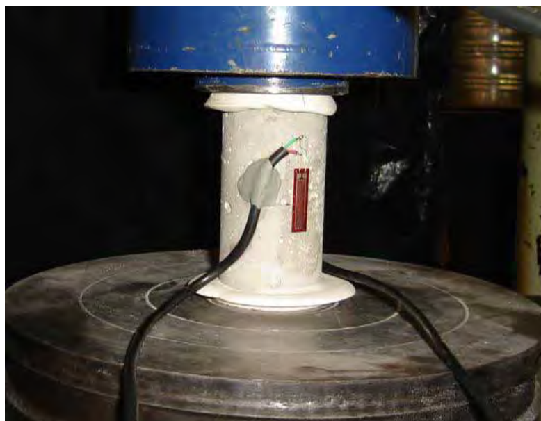
Figura 5.21 - Corpo-de-prova de graute instrumentado e posicionado em máquina de ensaio
