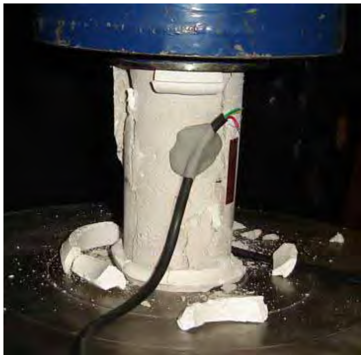
Figura 5.17 - Modo de ruptura dos corpos-de-prova de argamassa.
