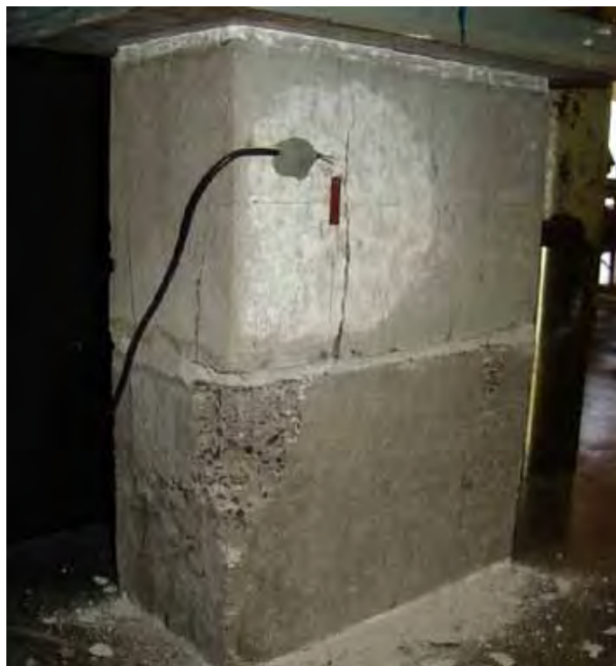
Figura 5.31 - Modo de ruptura do prisma PR2-A02.
