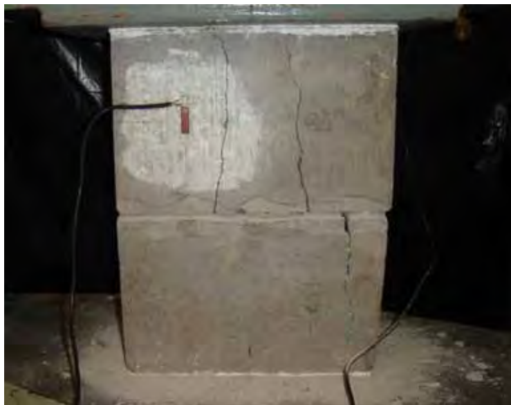
Figura 5.30 - Modo de ruptura do prisma PR2-A01.
