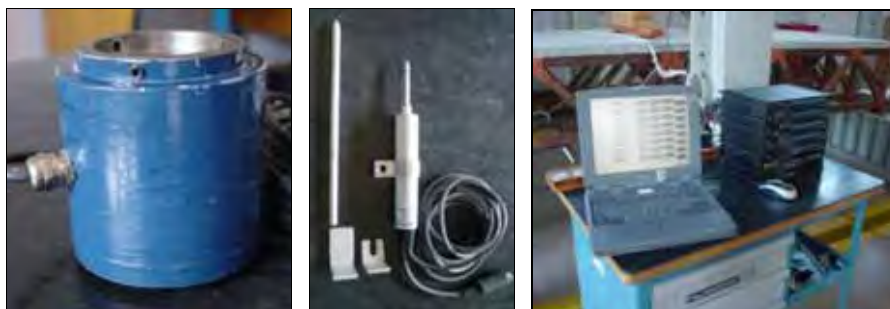
Figura 5.28 - Instrumentos utilizados no trabalho: célula de carga, LVDT, sistema de aquisição.
