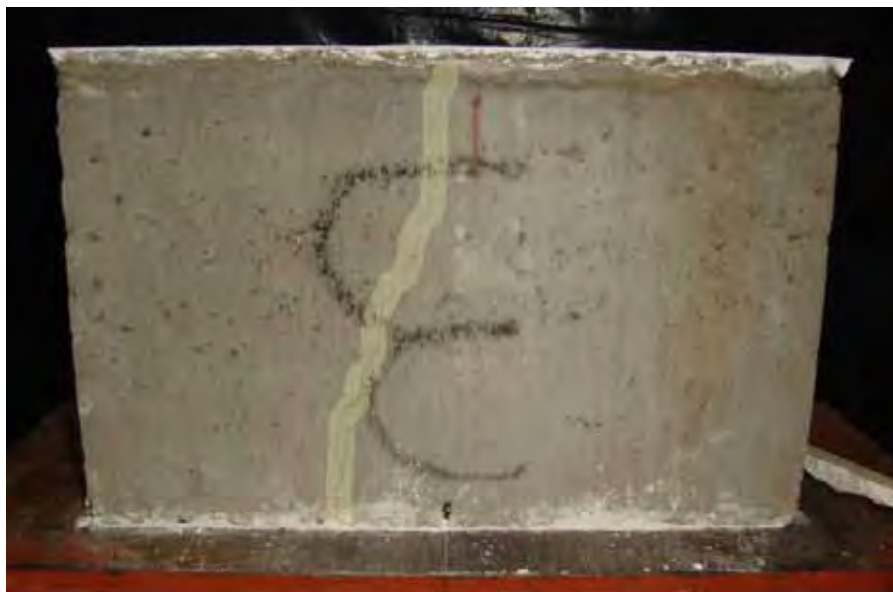
Figura 5.9 - Modo de ruptura dos blocos vazios
