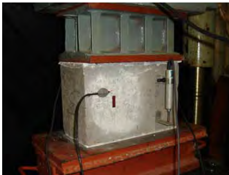
Figura 5.5 - Bloco instrumentado durante ensaio de carregamento
