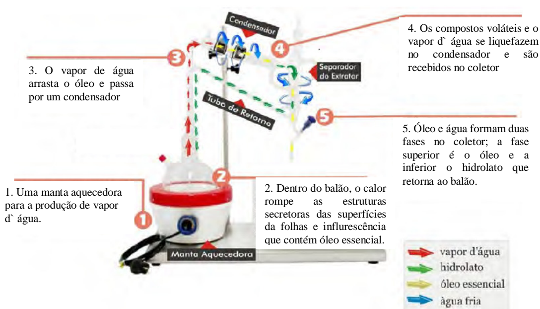
Figura 24. Esquema do Sistema Clevenger utilizado para a extração de óleo essencial Fonte: JOSÉ, 2014, p.73.
