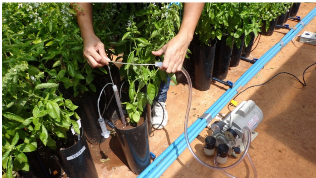
Figura 22. Aplicação de vácuo no extrator de cápsula porosa, para coleta de solução
