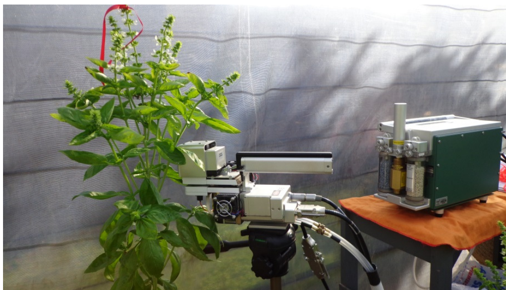
Figura 23. Analisador infra vermelho de gases (IRGA) modelo LI-6400XT (LI-COR, Lincoln, Nebraska – USA)
