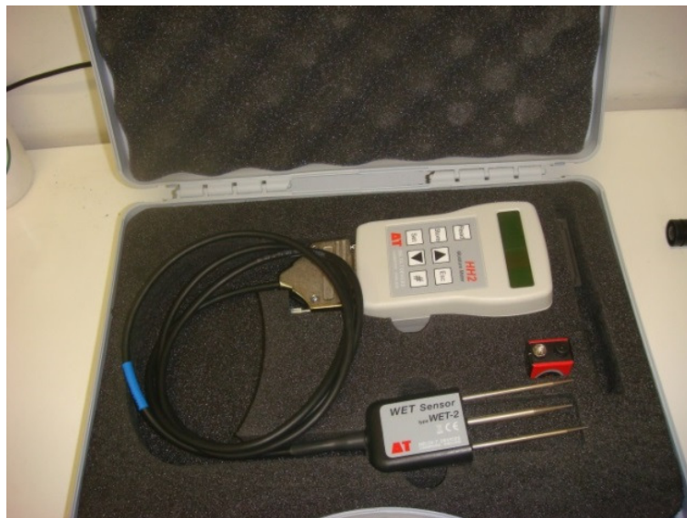
Figura 20. Sensor WET-2-K1 (Delta T) utilizado no experimento
