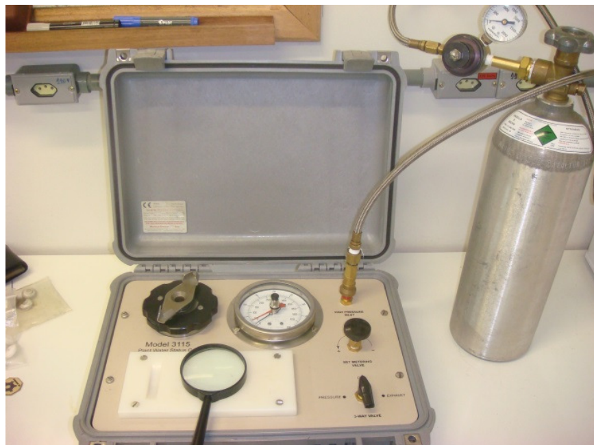
Figura 18. Câmara de pressão modelo SAPS II - System Analysis of Plant Stress, mod. 3115
