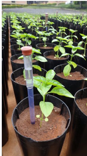
Figura 14. Monitoramento de água no solo por tensiometria
