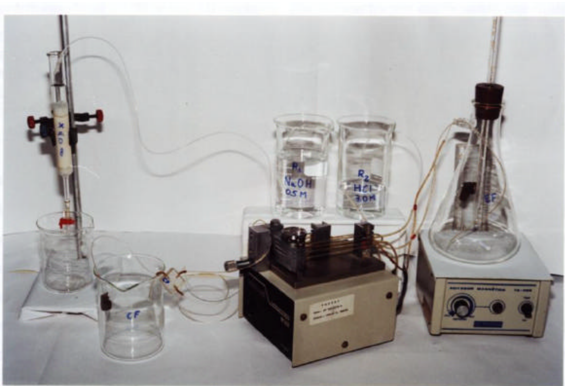
Figura 2.4 - Sistema em fluxo para extração, fracionamento das substâncias húmicas e purificação de ácido fúlvico de solos.
