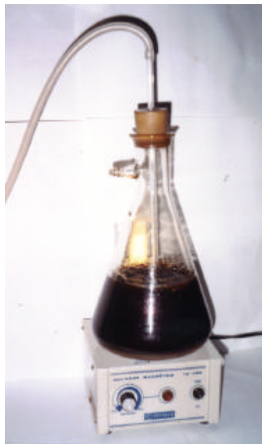
Figura 2.2 - Sistema extrator utilizado na extração das substâncias húmicas de solos por batelada.
