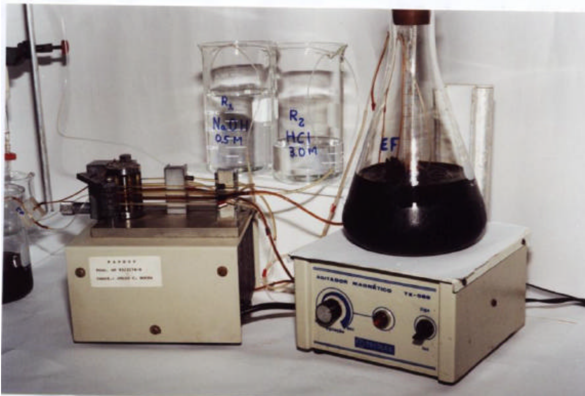
Figura 2.6 - Frasco de extração (FE), tubos de Tygon para bombeamento, bomba peristáltica, recipientes para armazenamento de soluções de NaOH 0,5 \text{ mol L}^{-1} ( R_1 ) e HCl 3,0 \text{ mol L}^{-1} ( R_2 ).
